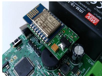
Figura 18. Instalación del módulo "W25M"
