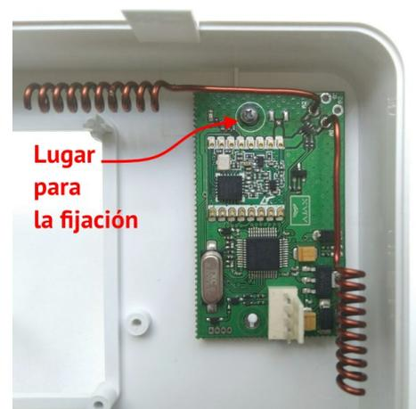
Figura 16. Receptor de radio “Ajax” en el cuerpo del Panel de control
