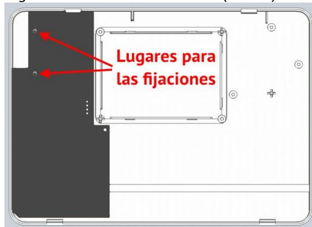
Figura 11. Módulo de radio “Lun-R” en el cuerpo del Panel de control
