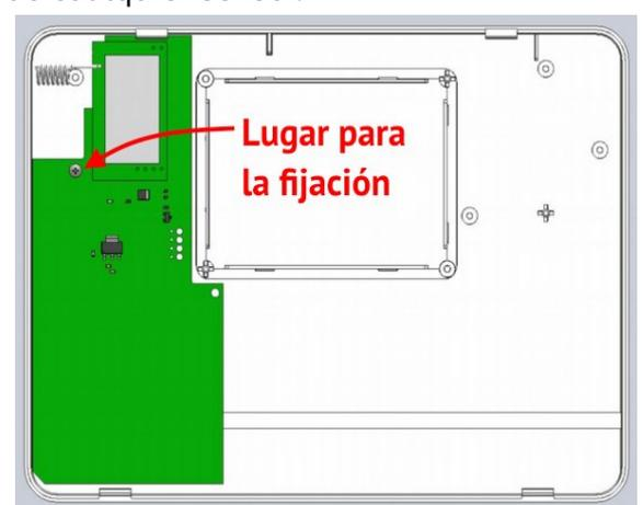
Figura 13. Módulo de radio “L25-Crow rev.3” en el cuerpo del Panel de control
