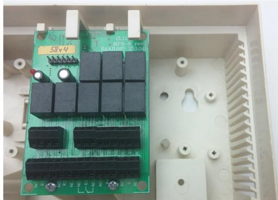
Figura 18. Módulo “MPB-8M” en la carcasa del dispositivo
