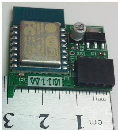
Figura 36. Imagen general del módulo “W11M”
