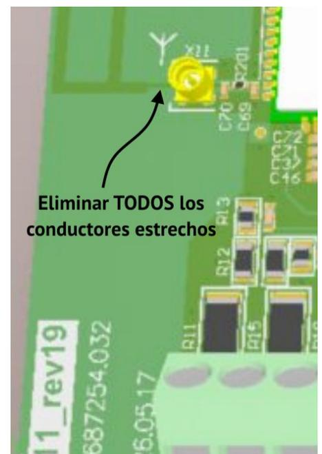
Figura 6. Preparación de la placa de revisión 19 para conectar una antena externa
