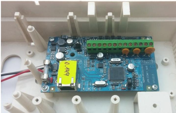
Figura 32. Comunicador “LanCom” en rev.15 en la carcasa del equipo
