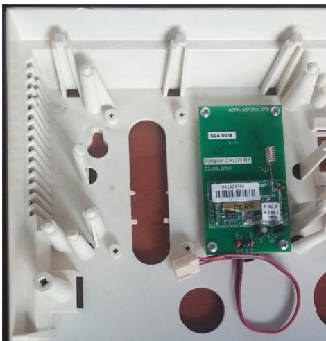
Figura 26. Adaptador “Crow-Lun-11” en la carcasa del equipo
