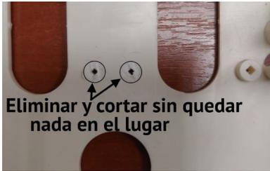
Figura 28. Preparando lugar para el adaptador "L25\_Crow\_rev3"
