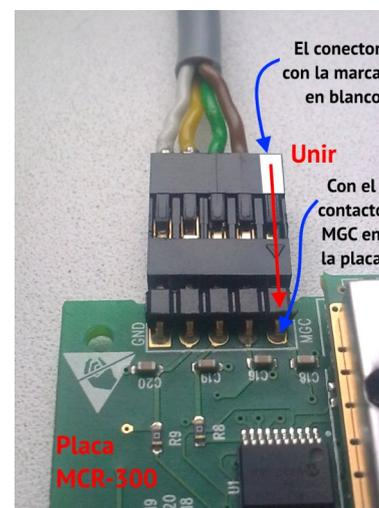
Figura 24. Conectando el cable al receptor Visonic
