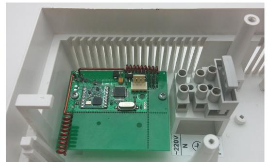
Figura 31. Receptor inalámbrico Ajax "uartBridge" en la carcasa del equipo
