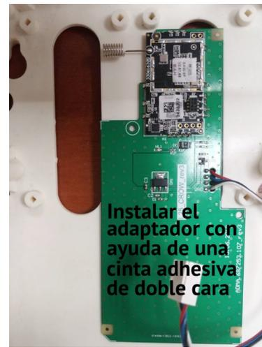
Figura 29. Adaptador "L25\_Crow\_rev3" en la carcasa del equipo
