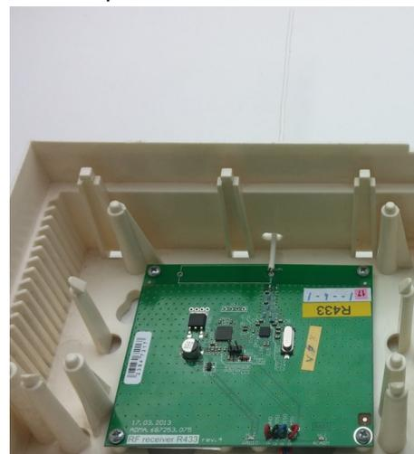
Figura 21. Receptor inalámbrico “P433” rev.4 con la antena en el cuerpo del equipo
