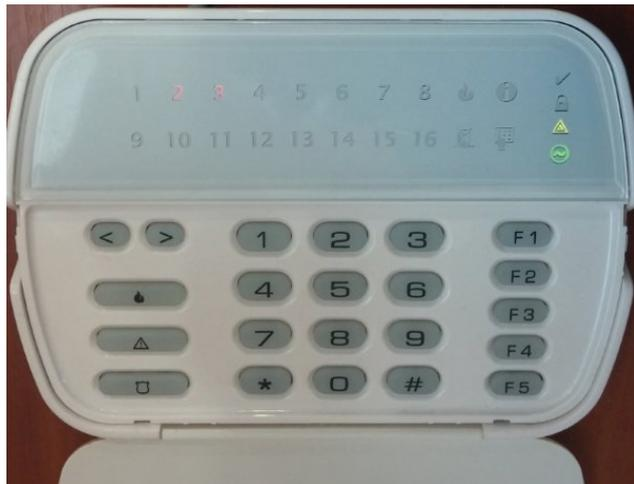
Figura 16. Imagen externa del DIC “Lind-11LED” con tapa abierta
